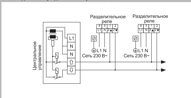
Параллельное подключение разделительных реле 0387 00
